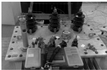
图8 三芯电缆温升试验实物图
